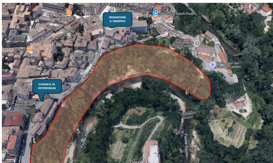
Fig. 2 - Estratto 3D google maps in direzione Est-Ovest, con rappresentazione indicativa del perimetro PAI frana vigente e localizzazione dei complessi storici, danneggiati dal sisma ed esposti al rischio di dissesto gravitativo.
